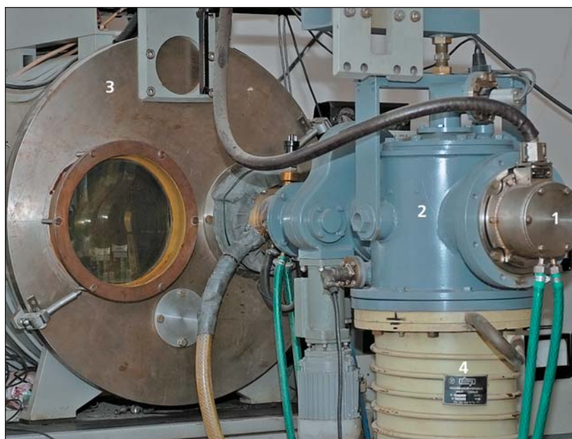
Общий вид электронно-пучкового плазмохимического реактора: 1 — электронная пушка, 2 — высоковакуумная камера, 3 — реакционная камера, 4 — высоковакуумный насос.
