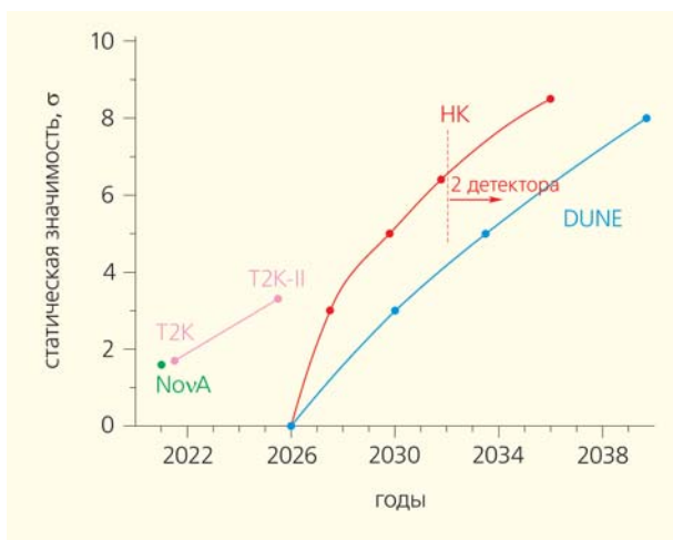
Рис.8. Ожидаемая чувствительность (в единицах \sigma ) к нарушению CP-симметрии, которая может быть достигнута в текущих (T2K, NOvA) и готовящихся экспериментах T2HK (обозначен как HK) и DUNE [21]. Также показана чувствительность второй фазы эксперимента T2K, которая обозначена как T2K-II. Оценки чувствительности сделаны для \delta_{CP} = -\pi/2 и нормальной иерархии масс. Предполагается, что эксперименты T2HK и DUNE начнут набор статистики в 2026 г.
