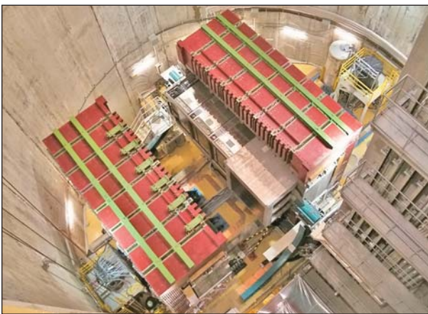
Рис.2. Ближний нейтринный детектор эксперимента T2K: модель (вверху) и фотография с открытым магнитом.
